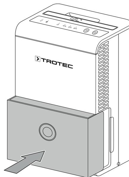
4. Deje que el filtro se seque completamente. No coloque nunca en el aparato filtros que aún estén húmedos.
