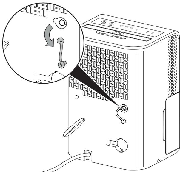
2. Conecte uno de los extremos de la manguera en la conexión de manguera.
