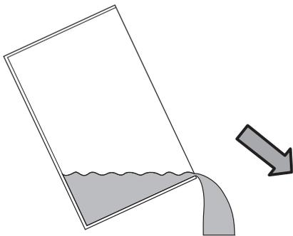
3. Aclare el depósito con agua limpia. Limpie el depósito regularmente con un producto de limpieza suave (¡no use lavavajillas!).
