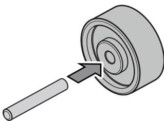
2. Incline el aparato. Introduzca uno de los rodillos de transporte en los alojamientos de la parte inferior del aparato hasta que encaje. Repita este paso para los tres rodillos de transporte restantes.
