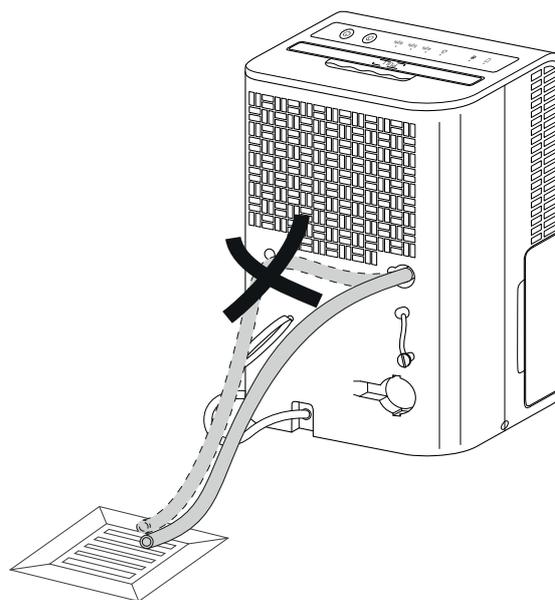
Cuando desee volver a recoger el agua condensada en el depósito quite la manguera. Deje secar la manguera antes de guardarla. La manguera puede ser conectada de manera permanente en cualquier modo de funcionamiento.
