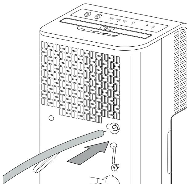
3. Conecte el otro extremo de la manguera a un desagüe apropiado (por ejemplo un sumidero o un recipiente colector suficientemente grande). Asegúrese de que la manguera no se pueda doblar.
