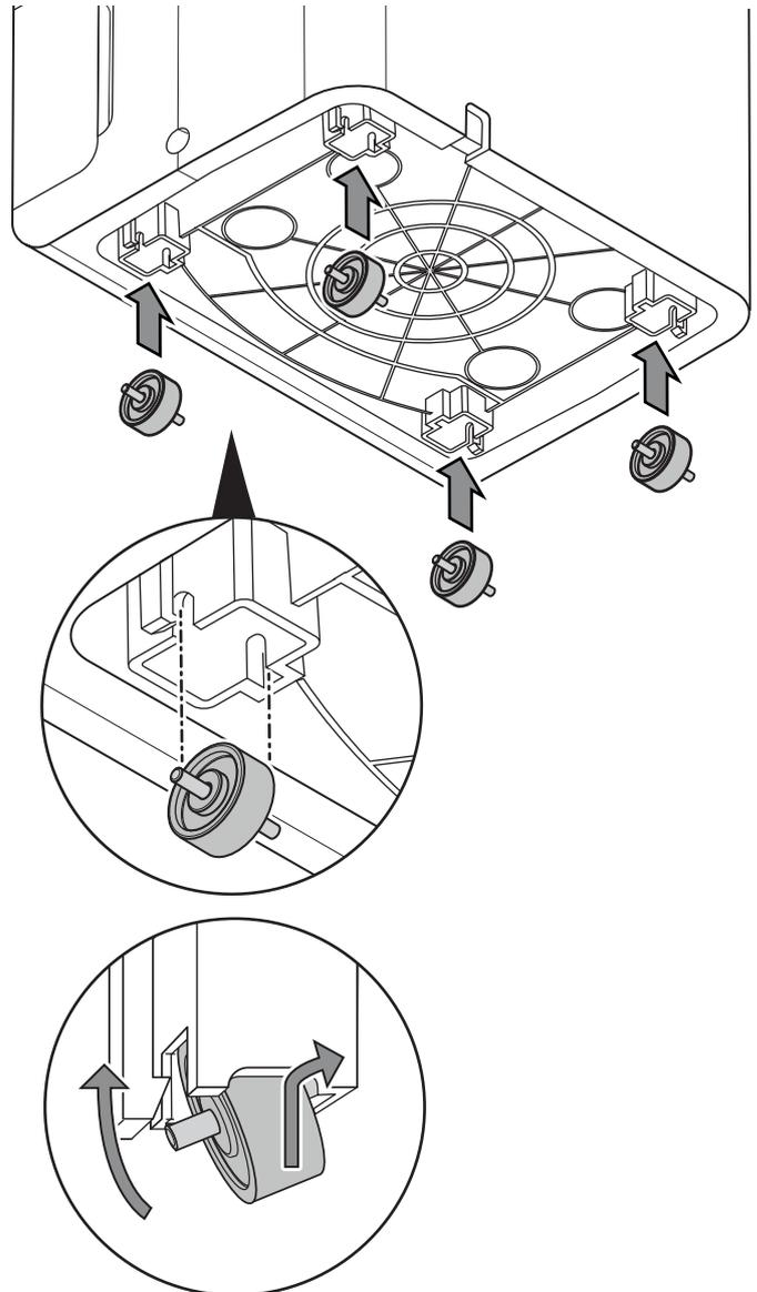
3. Después de fijar los rodillos de transporte, coloque el aparato en posición vertical.
