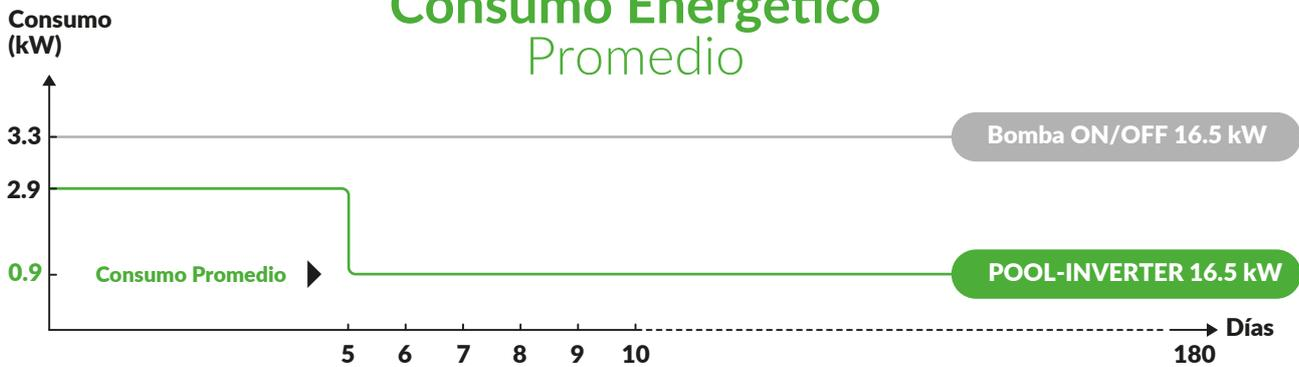
POOL-INVERTER vs Bombas ON/OFF (Ej: 16.5 kW Aire 26°C/ Agua 26°C/ Humedad 80%)
